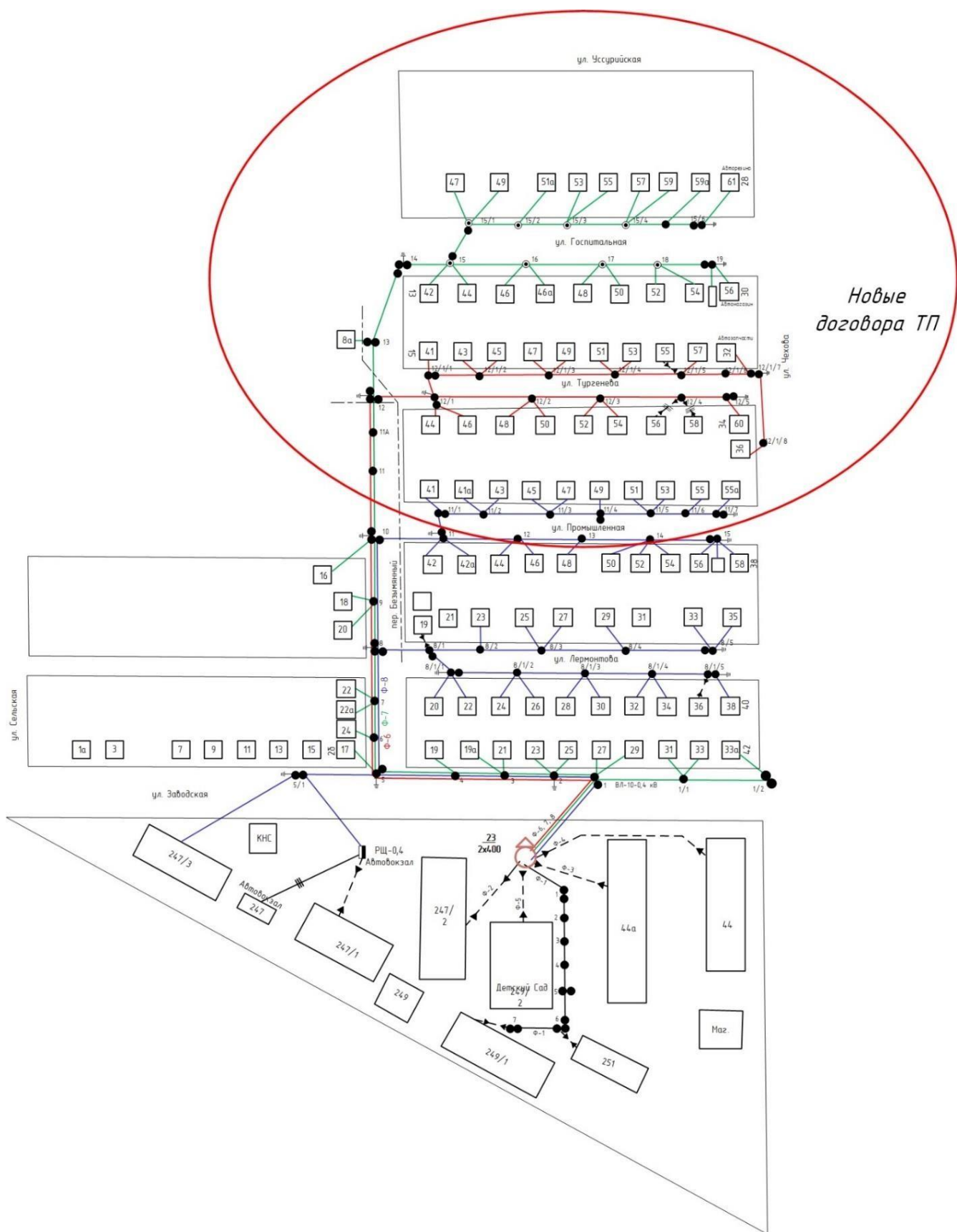
Рисунок 3 – Схема подключения электроприёмников к ТП-23
