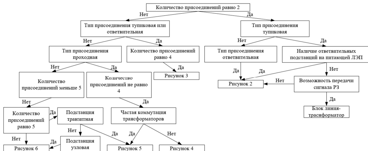
Рисунок 13 – алгоритм выбора схемы распределительного устройства ВН
