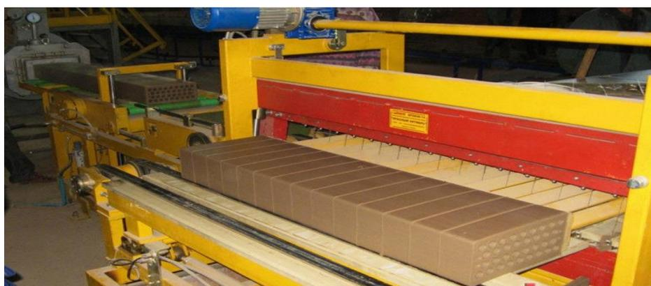
Рисунок 12 – Линия по производству строительного кирпича из глины
