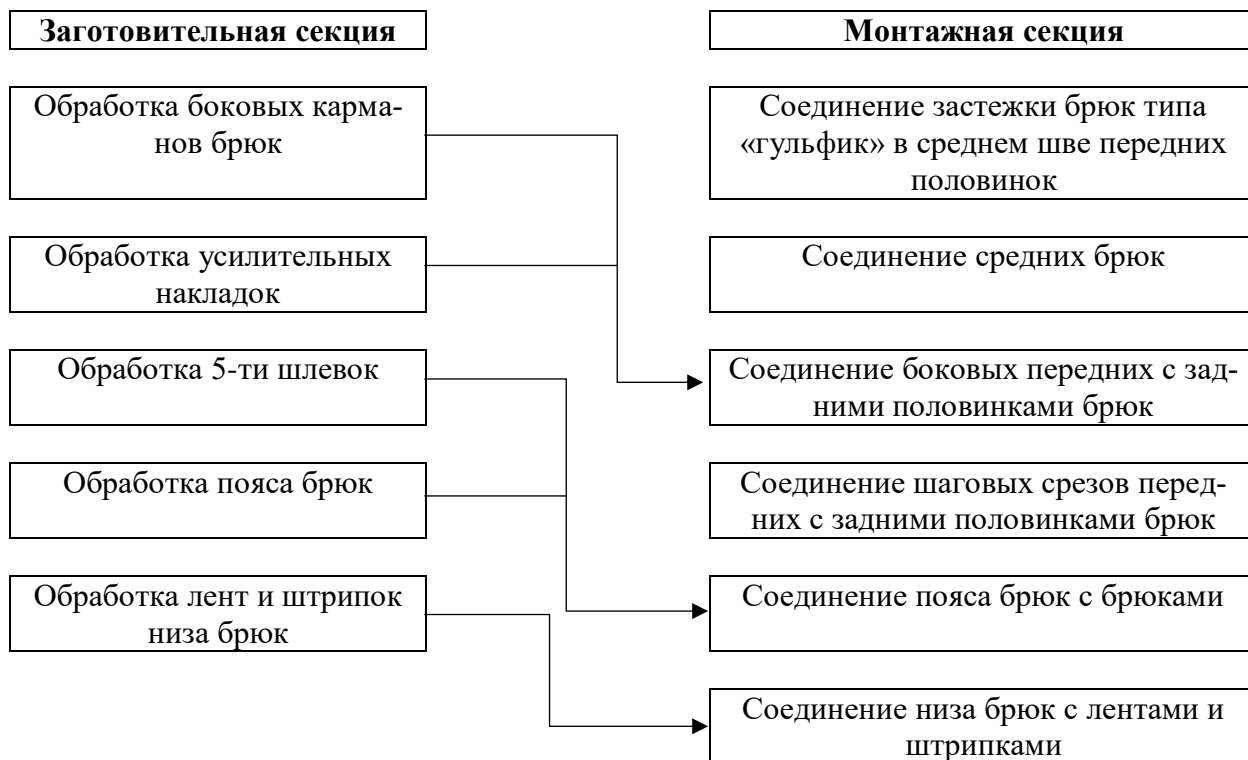
Рисунок Л.2 – Схема изготовления брюк костюма сотрудников УИС
