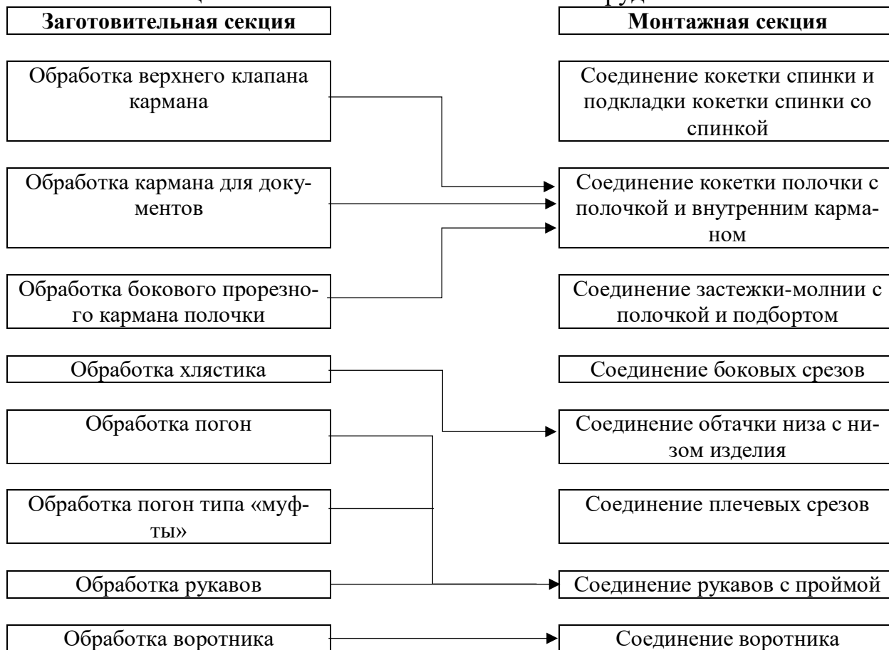
Рисунок Л.1 – Схема изготовления куртки костюма сотрудников УИС
