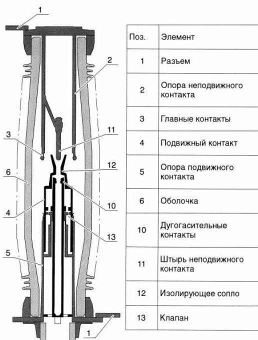
Рисунок 12 – Состав дугогасительной камеры
