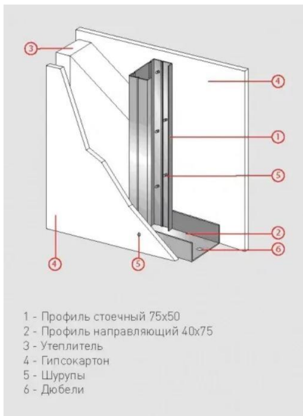
Рисунок Д.2– Способ монтажа стен из ГКЛ
