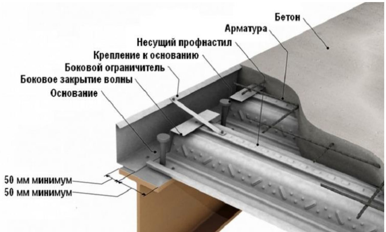
Рисунок Д.1 – Устройство бетонного монолитного перекрытия
