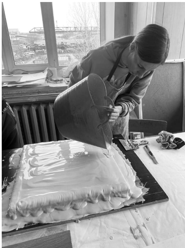
Рисунок Д.5 –Заливка кожуха
