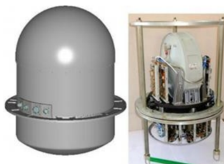
Рисунок 27 – Внешний вид гиродина СГК-20-20 и его компоновка
