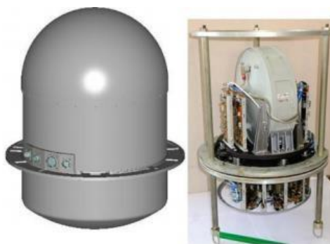
Рисунок 22 – Силовой гиросприбор 14М533 и его компоновка
