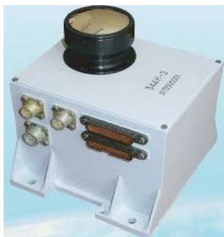
Рисунок 15 – Инфракрасный построитель местной вертикали
