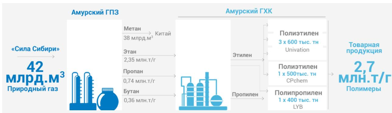
Рисунок 2 – Схема взаимосвязи проектов АГПЗ и АГХК
