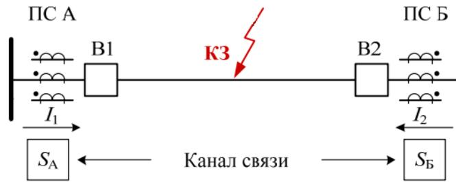
Рисунок 23 – Принцип действия ДЗЛ
