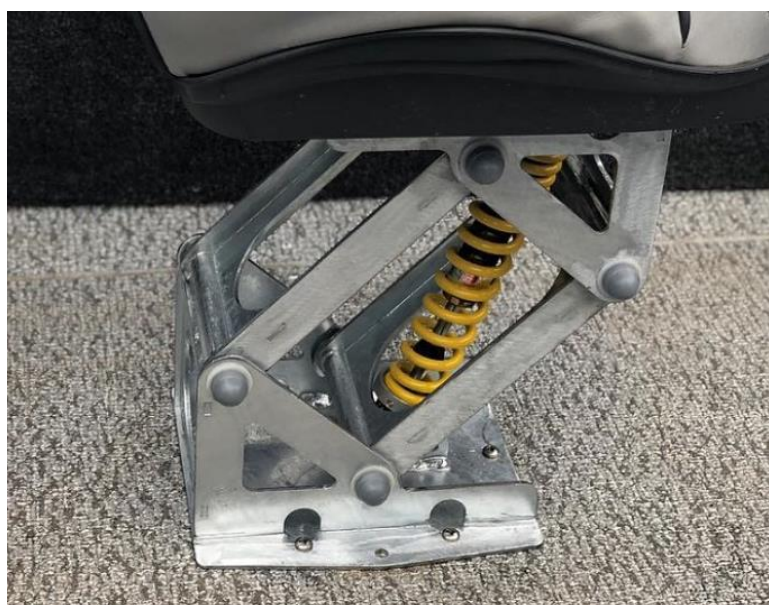
Рисунок 6 – Кресло с механическими рессорами
