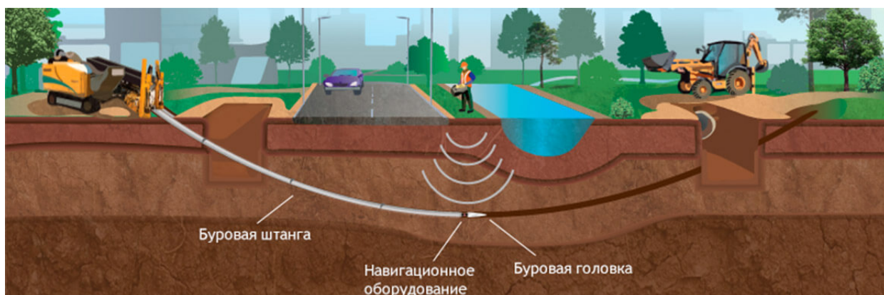
Рисунок 14 – Принцип выполнения горизонтально – направленного бурения грунта
