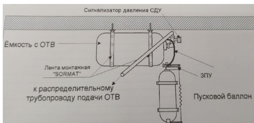
Рисунок 10 – Схема установок емкости с ОТВ и пускового баллона МУП ТВ-50-Г-ВД (вариант установки под перекрытием)
