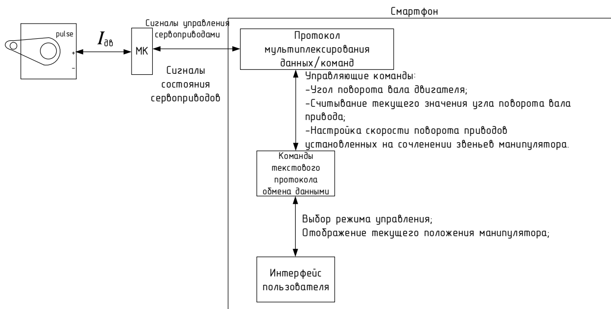
Рисунок 3 – Структурная схема системы управления роботом манипулятором
