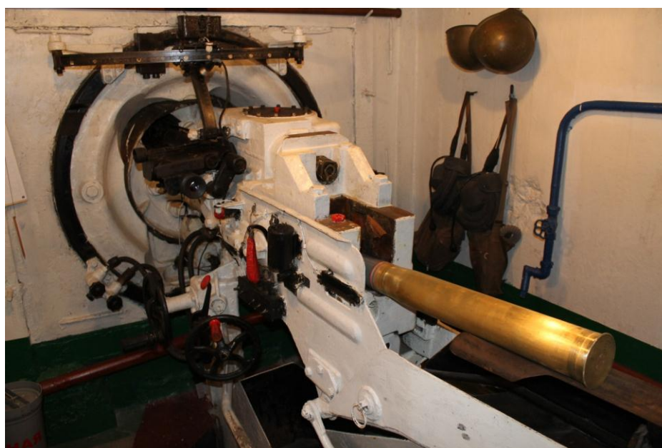
Рис.12 - Артиллерийская казематная установка ЗИФ-26 с 85-мм орудием с установленным прицелом ПУР-26
