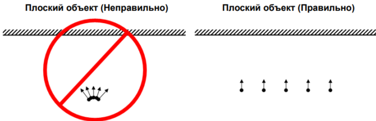
Рисунок 3.2 – Алгоритм съемки плоских объектов
