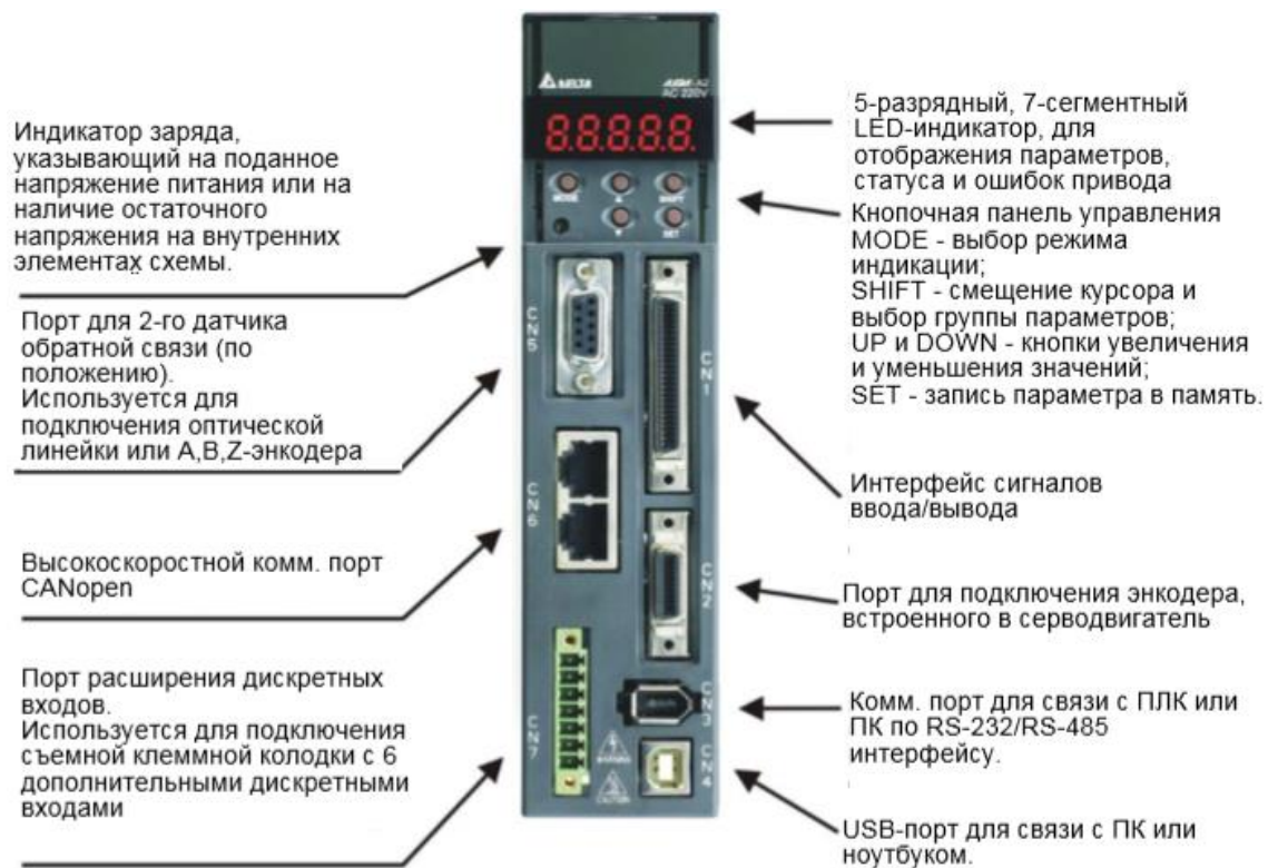
Рисунок 9 - Назначение элементов лицевой панели
