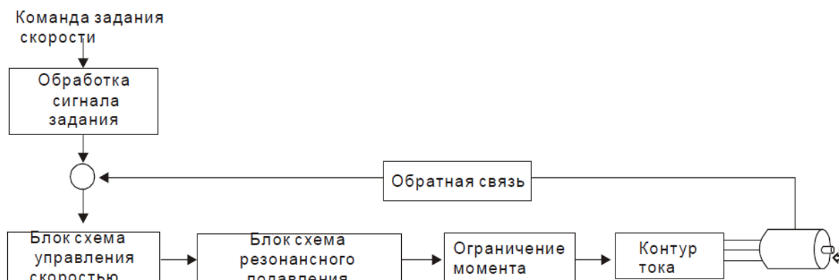
Рисунок 15 – Схема процесса регулирования скорости
