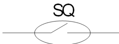
Рисунок 39 – Принципиальная схема геркона
