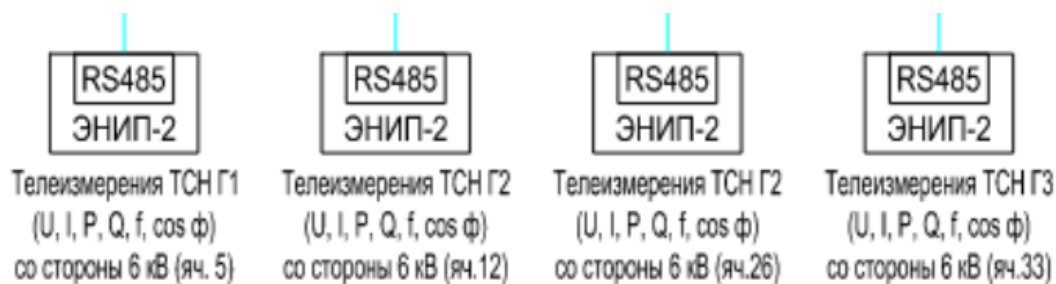
Рисунок 7 - Ячейки КРУ 6 кВ собственных нужд
