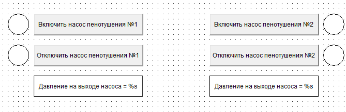
Рисунок 45 – Щит управления насосами пенотушения
