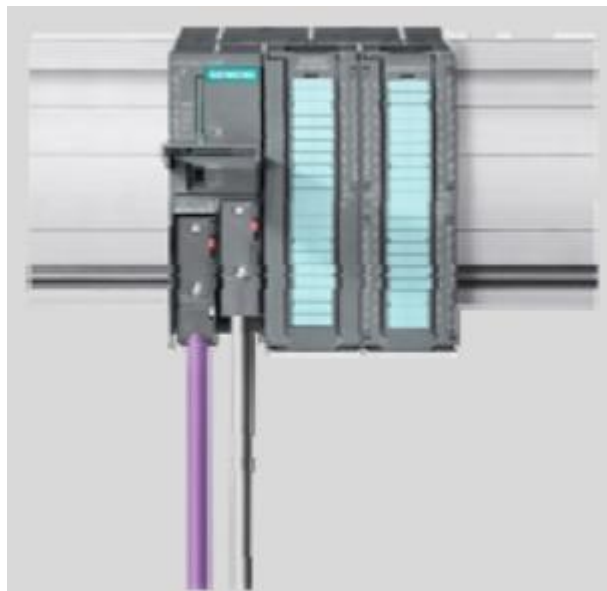
Рисунок 27 – Общий вид Siemens S7-300
