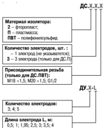
Рисунок 20 – Условное обозначение кондуктометрических датчиков ОВЕН
