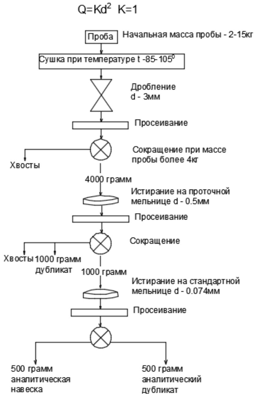
Рисунок 9 - Схема обработки керновых и борзодовых проб
