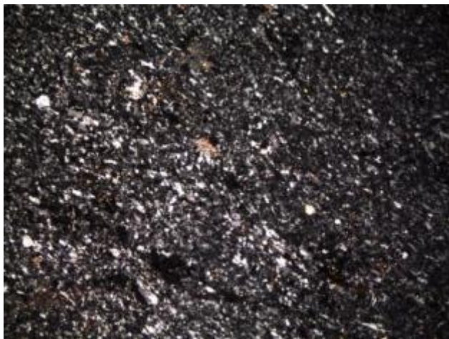
Рисунок 8 - Апотуф без вкрапленников. Николи скрещены. Увеличение в 25 раз.
