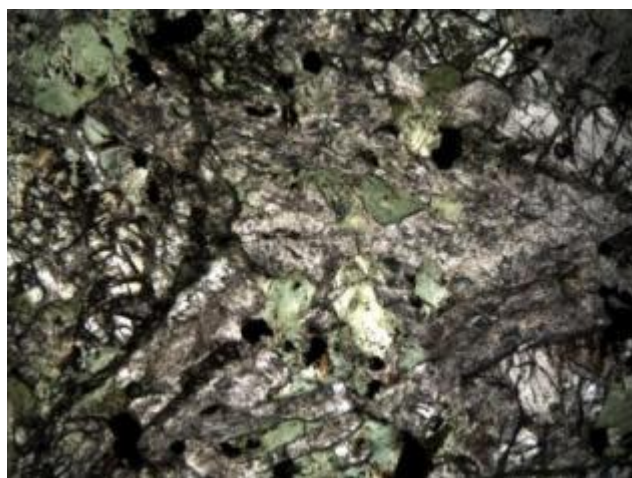
Рисунок 13 - Габбро (Без николей и в скрещенных николях). Увеличение в 25 раз.
