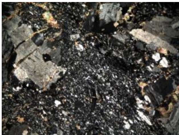
Рисунок 6 - Вкрапленники альбита в кварц-альбитовой ксеноморфной массе.
