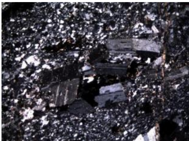
Рисунок 6 - Вкрапленники альбита в кварц-альбитовой ксеноморфной массе.
