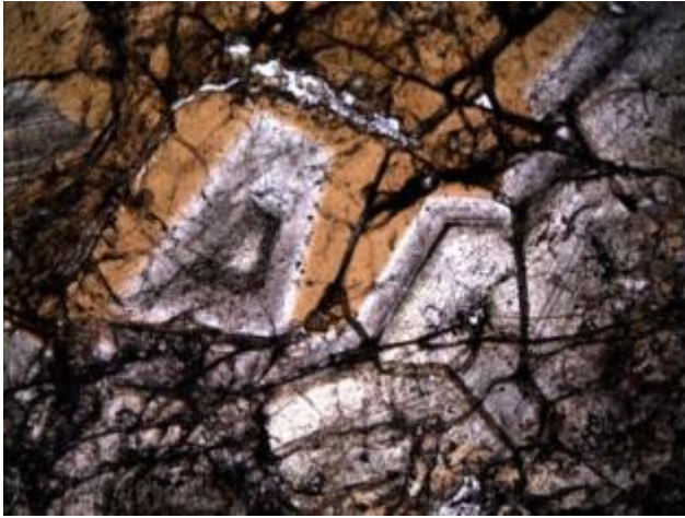
Рисунок 12 - Зональные зерна граната в скарноиде. Без николей. Увеличение в 25 раз.
