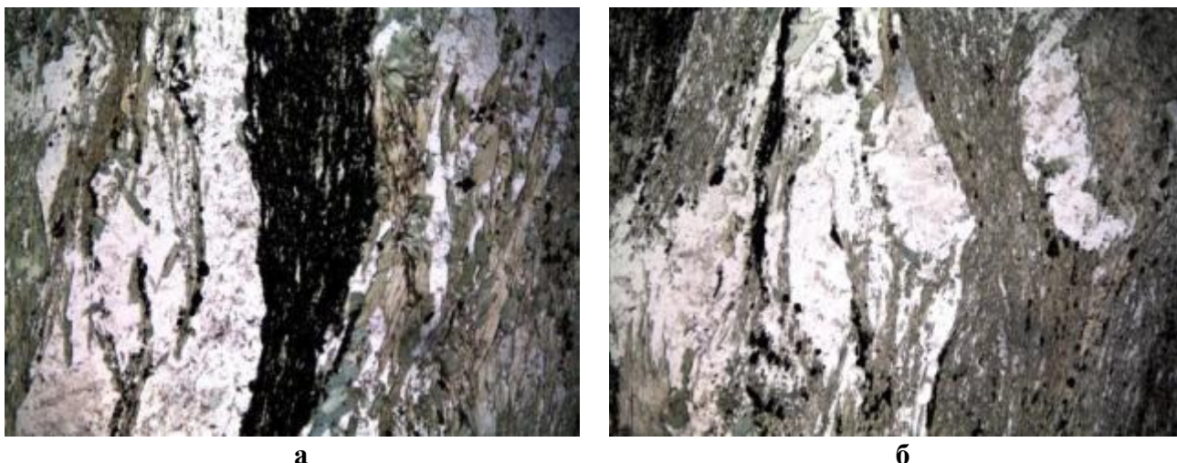
Рисунок 11 - Апотуф со сланцеватой текстурой. Без николей. Увеличение в 25 раз.
