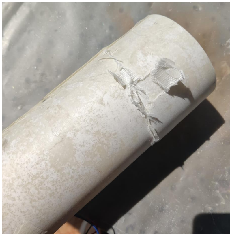
Рисунок 17 – Корпус после испытания на пресс установке
