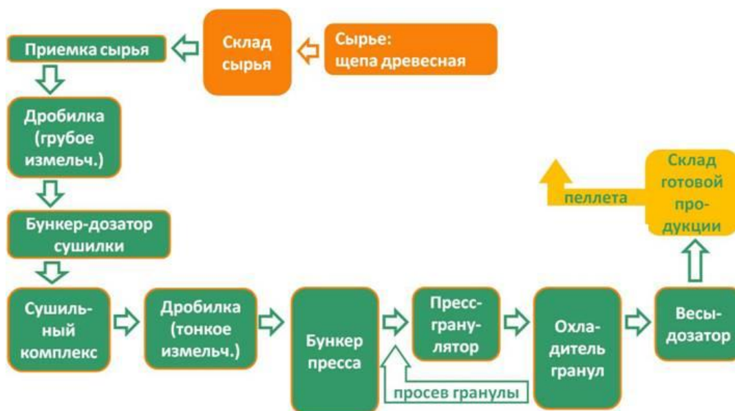
Рисунок 3 – Блок-схема технологического процесса по производству древесных пеллет
