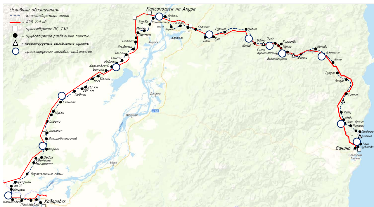
Рисунок 6 – Местоположения тяговых подстанций при электрификации участка
