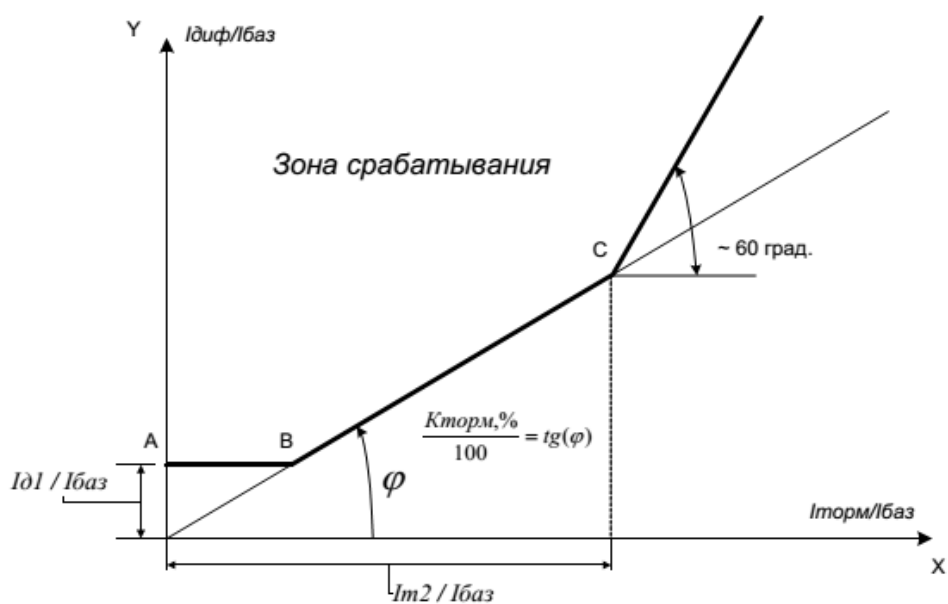
Рисунок 11 – Тормозная характеристика ступени ДЗТ-2 (чувствительная дифференциальная токовая защита с торможением)
