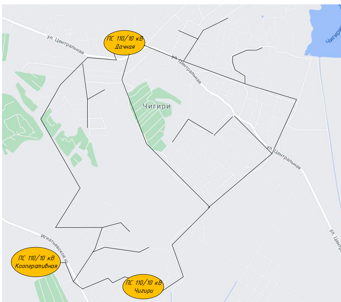
Рисунок 1 – Схема питания п. Чигири 6-10 кВ с главными кольцевыми фидерами от подстанций
