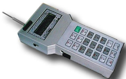
Рисунок 14 – Мобильный пульт переноса информации (ридер) РМРМ-2055РК
