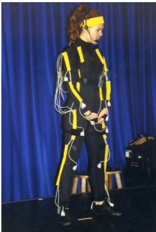
Рисунок 4 – Исполнитель в костюме для магнитного захвата движения
