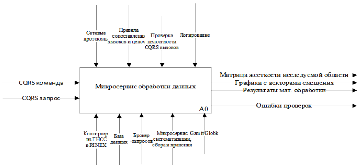
Рисунок 14 – Функциональная модель микросервиса обработки данных в нотации IDEF0
