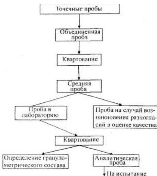
Рис. 6. Схема обработки проб
