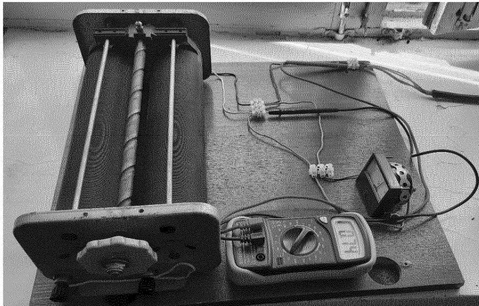
Рисунок 19 – Тестовая система, реостат подключён последовательно.
