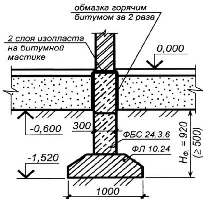
Рисунок 1—Ленточный фундамент
