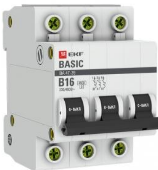
Рисунок 41 – автомат защиты 3P 16А (В) 4,5кА ВА 47-29 EKF Basic.
