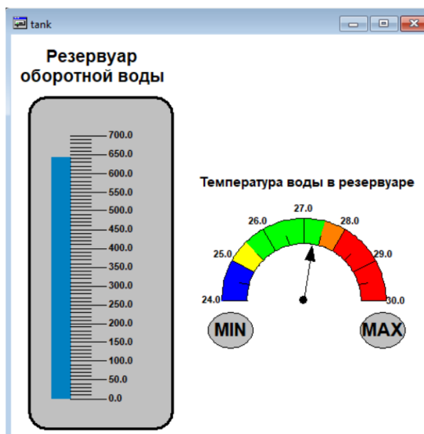
Рисунок 52 – Визуализация значений уровня и температуры воды резервуара
