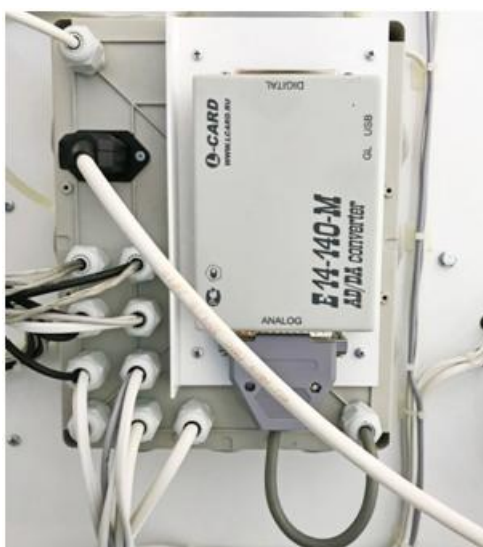
Рисунок 1.3 – Плата АЦП-ЦАП, согласование измерительной системы с ПК На панели управления, рисунок 1.4, расположены следующие элементы:
