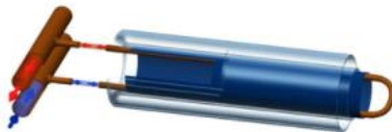
Рисунок 13 – Вид U-образной трубки солнечного коллектора
