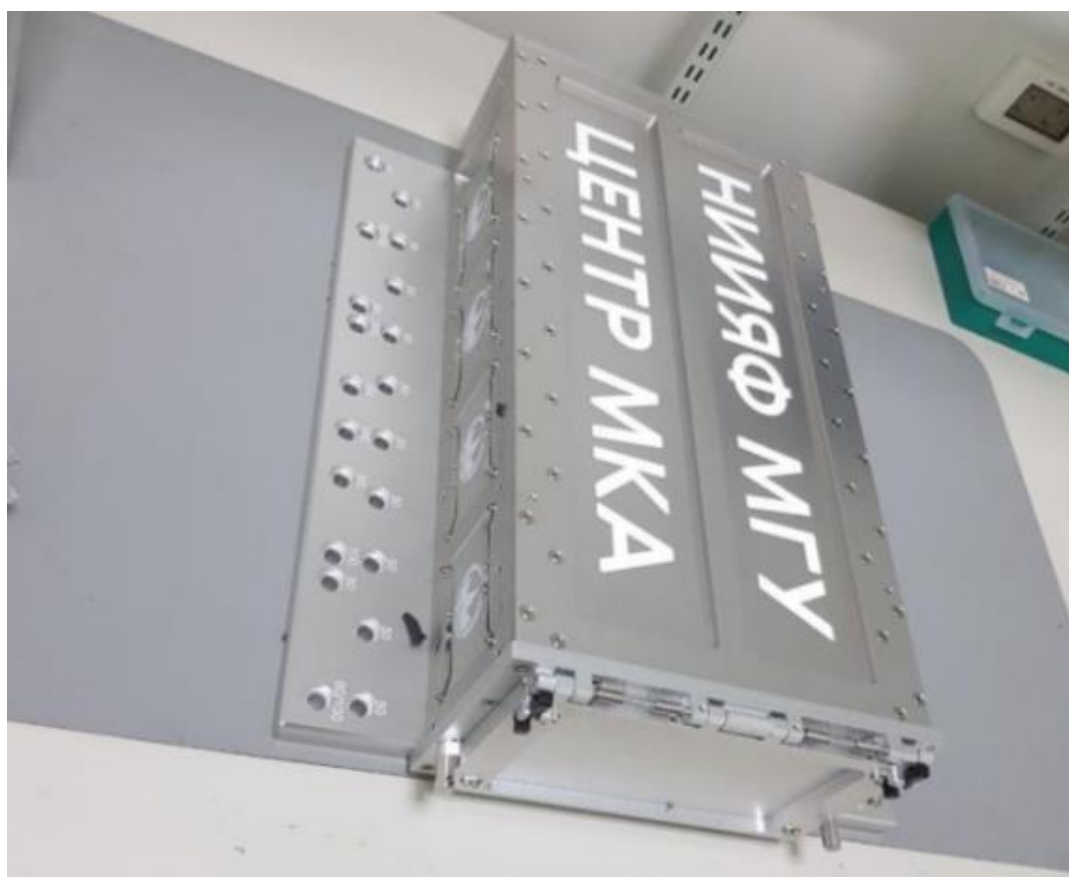
Рисунок 6 – Модификация ИТПК для МКА формата 6U CubeSat
