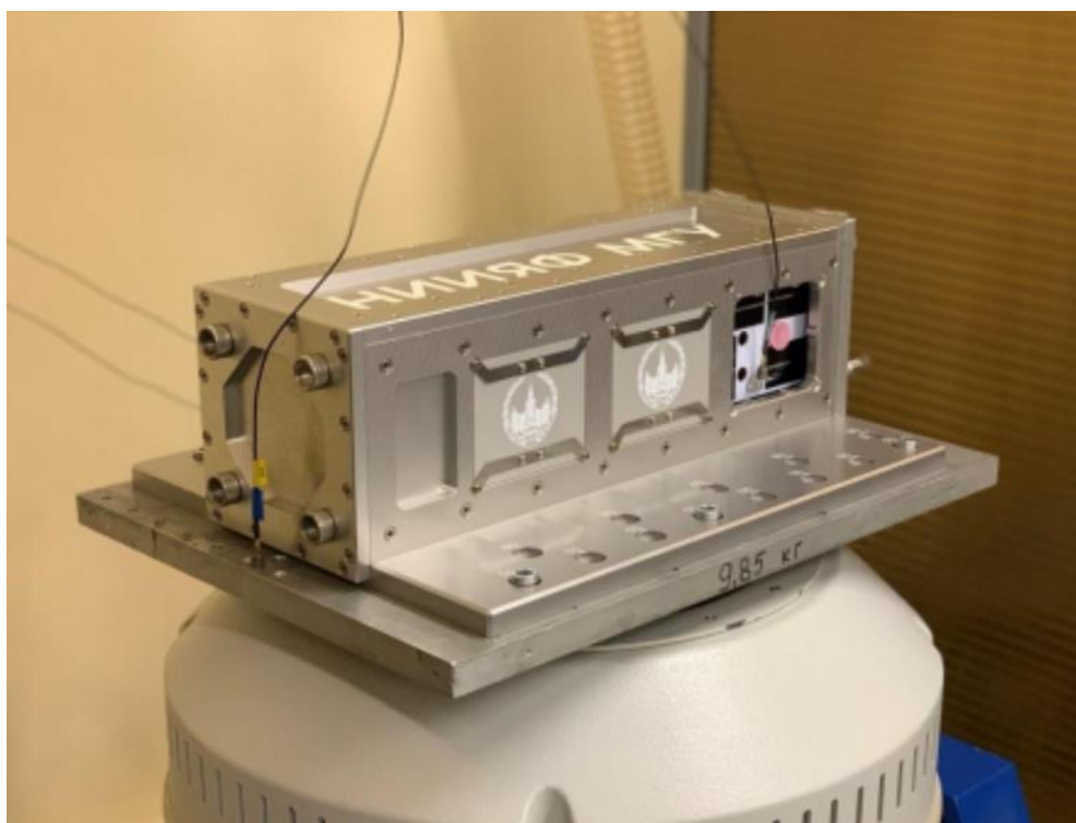
Рисунок 5 – Модификация ИТПК для МКА формата 3U в составе виб- ционного стенда
