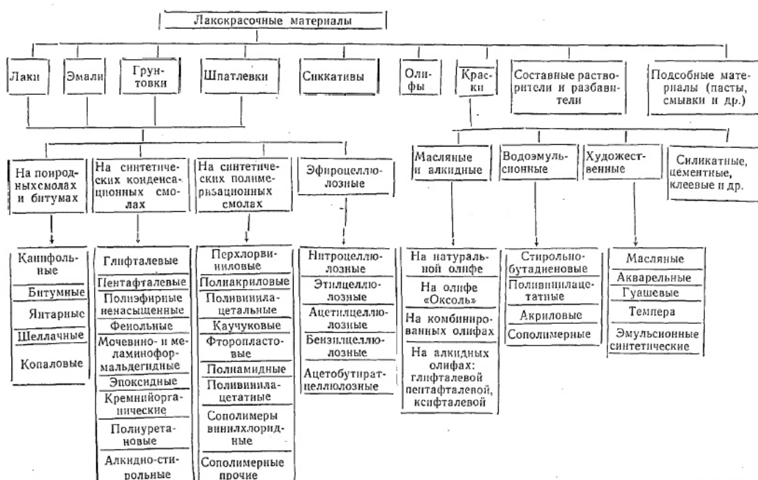
Рисунок 6 – Схема классификации лакокрасочных покрытий
