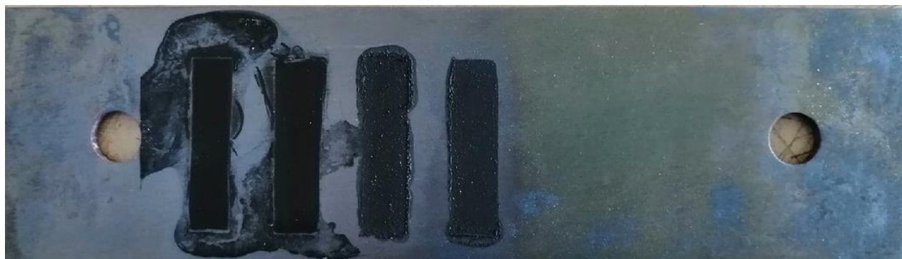
Рисунок 17 – Реальный вид стальной пластинки после нагревания до 600^\circ C
