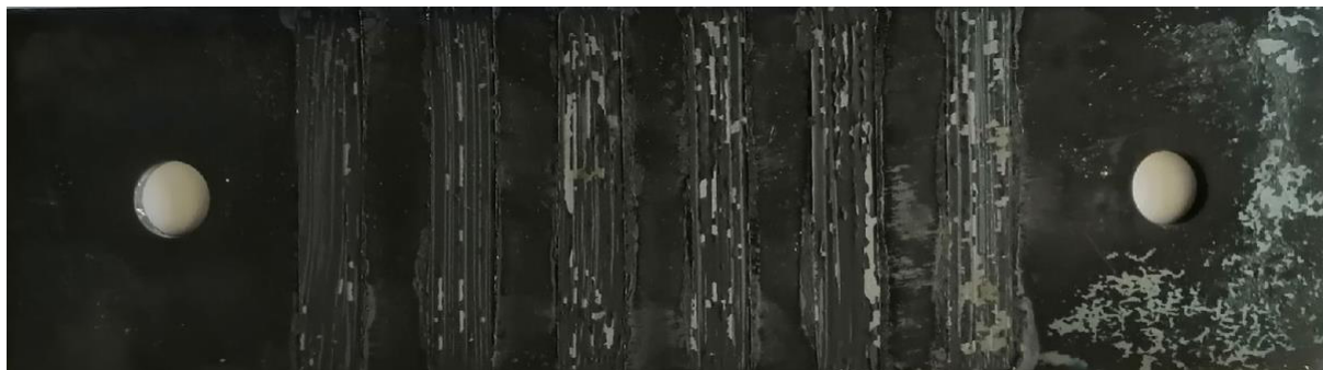
Рисунок 16 – Реальный вид стальной пластинки после нагревания до 600°C
