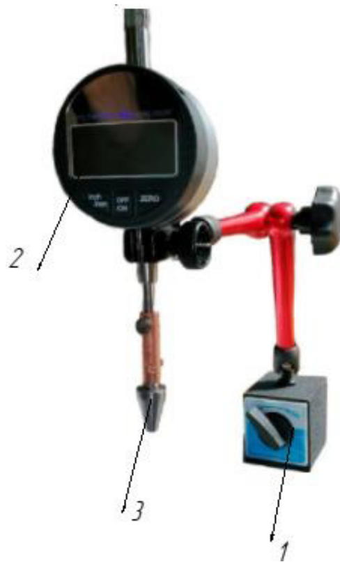
Рисунок 8 – Прибор для измерения твердости красок: 1 – магнитный штатив; 2 – микрометр; 3 – индентор
