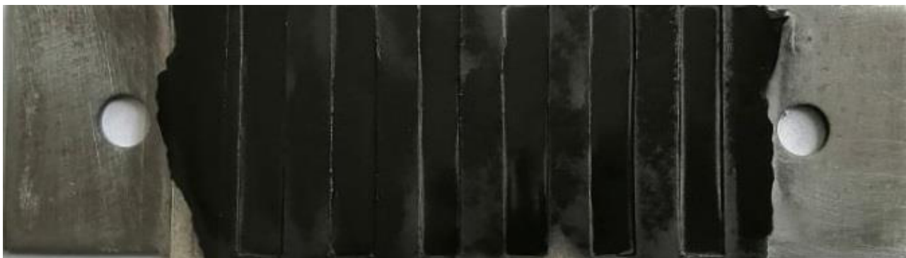
Рисунок 11 – Реальный вид стальной пластинки после нагревания до 600°C
