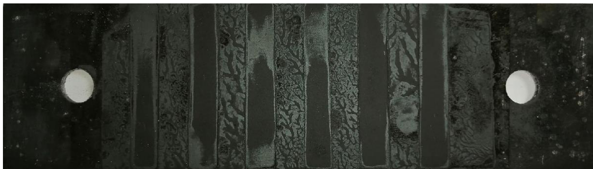
Рисунок 12 – Реальный вид стальной пластинки после нагревания до 600°C
