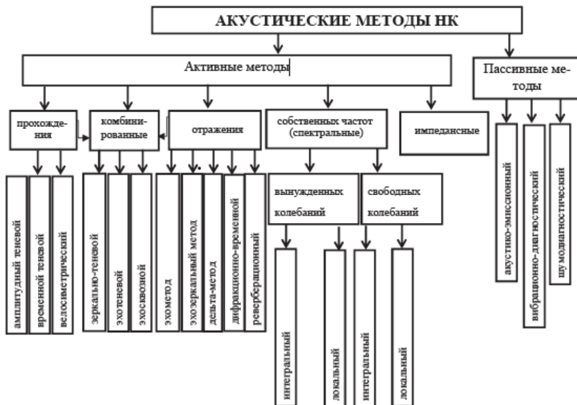
Рисунок 1 – Классификация акустических методов контроля и диагностики по ГОСТ 23829–85
