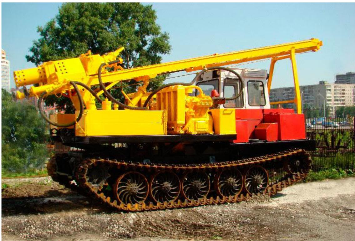
Рисунок 5 – Буровая установка УРБ – 4Т
