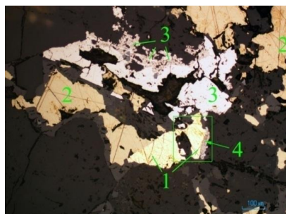
Рисунок 2.11 – Золото (1) в ассоциации с халькопиритом (2), пирит-марказитом (3). Кроме того, золото находится в тесном срастании с агрегатом, состоящим из гессита, матильдита, висмутина и самородного висмута (4). Полированный шлиф.
