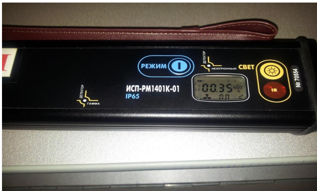
Рисунок - Показания дозиметрического прибора ИСП-PM1401К-01 при контроле ионизирующего излучения, исходящего от маркеров.
