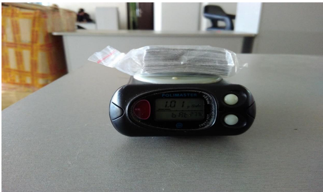
Рисунок - Показания прибора контроля «Полимастер» при контроле ионизирующего излучения, исходящего от наклеек
