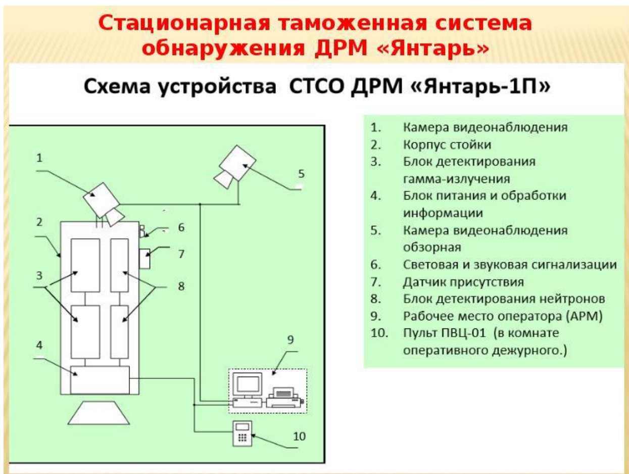
Рисунок – Схема устройства СТСО ДРМ «Янтарь – 1П»
