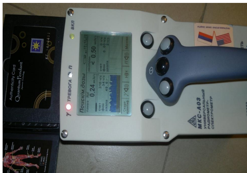
Рисунок - Определение ионизирующего излучения с помощью досмотрового прибора МКС-А03.
