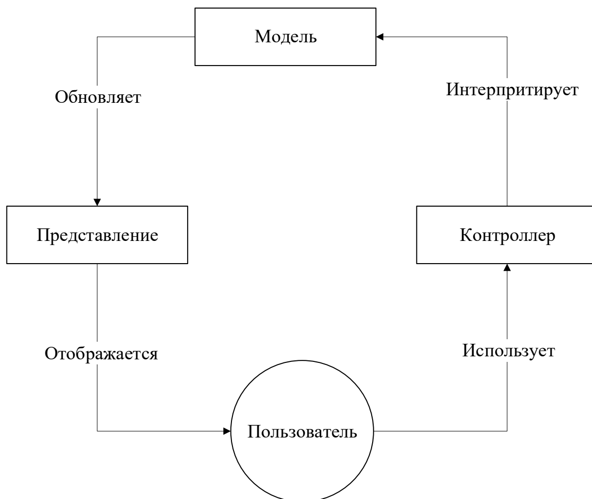
Рисунок 2 – Структурная схема работы приложения
