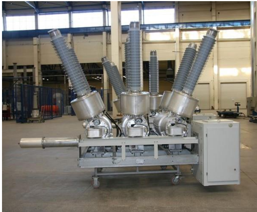
Рисунок 11 – Элегазовый выключатель ВЭБ-110
