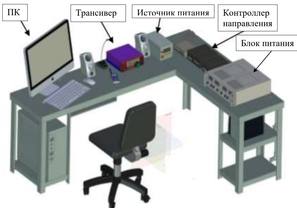
Рисунок 1 – Приемопередающее и управляющее оборудование станции
