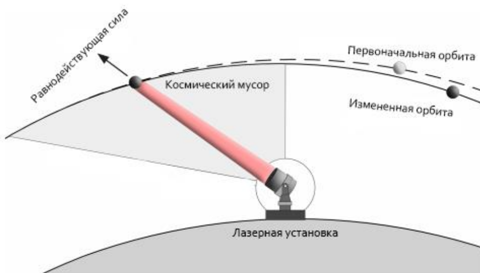
Рисунок 1 – Принцип работы «Лазерной метлы»
