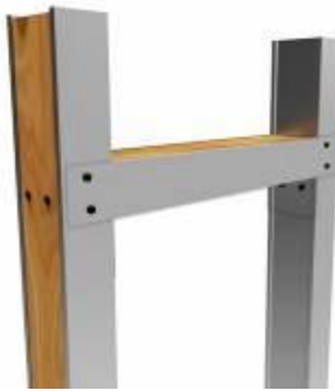
Рисунок 3 – Монтаж усиления гипсокартонной перегородки.
