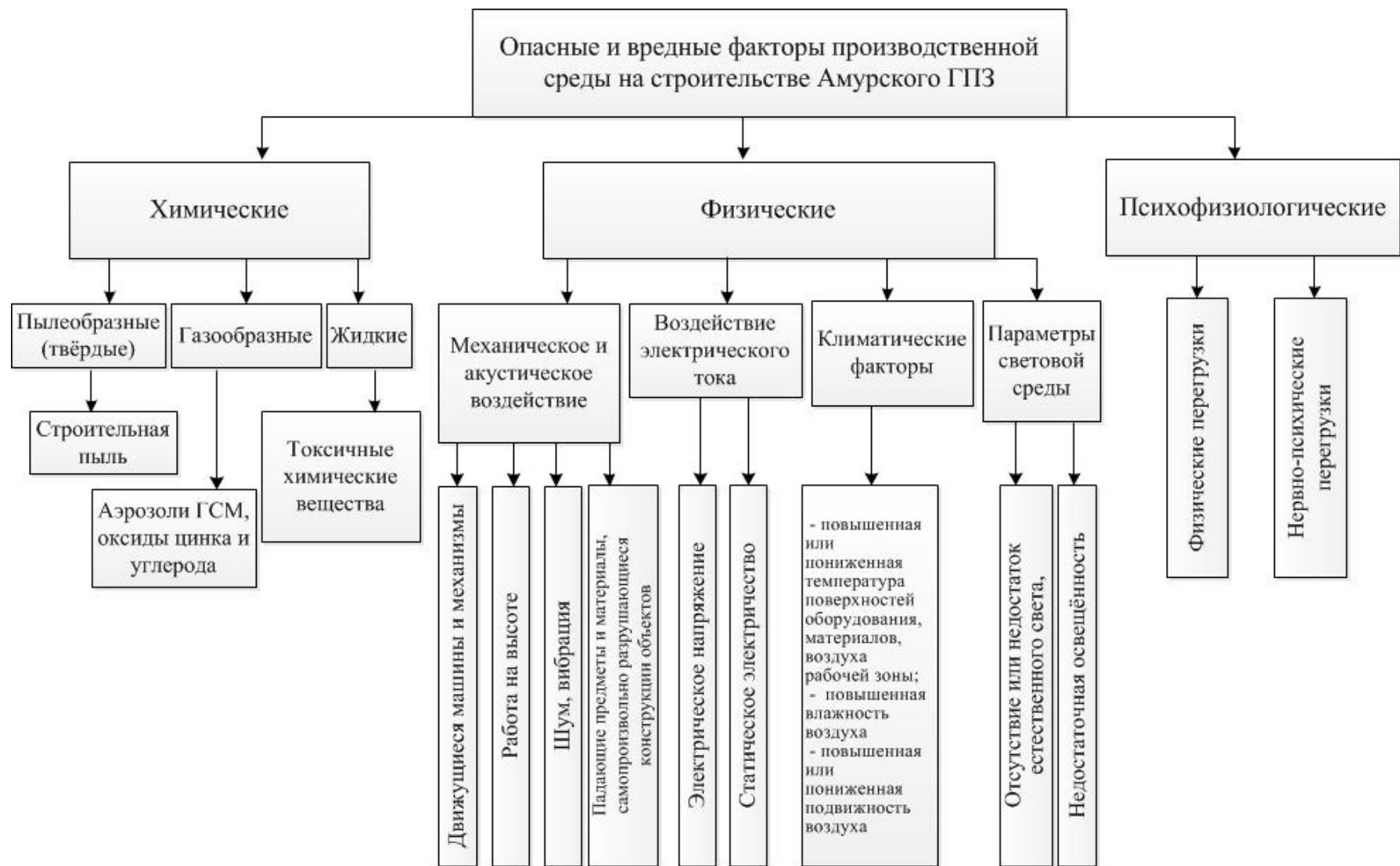
Рисунок 1.1 – Опасные и вредные факторы производственной среды на строительстве газоперерабатывающего завода
