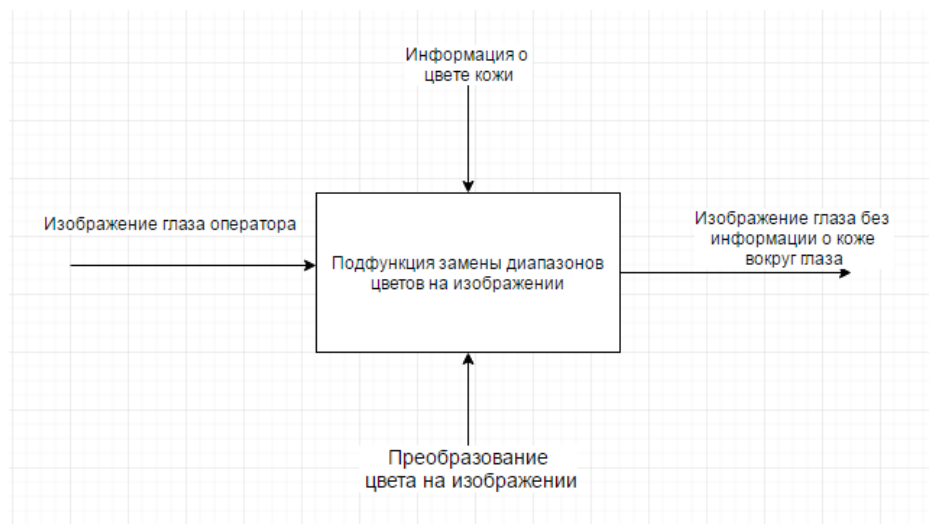
Рисунок 8 – Подфункция замены диапазонов цветов на изображении – подфункция преобразования изображения в оттенки серого. Функция оставит только один канал цвета, содержащий грации серого.
