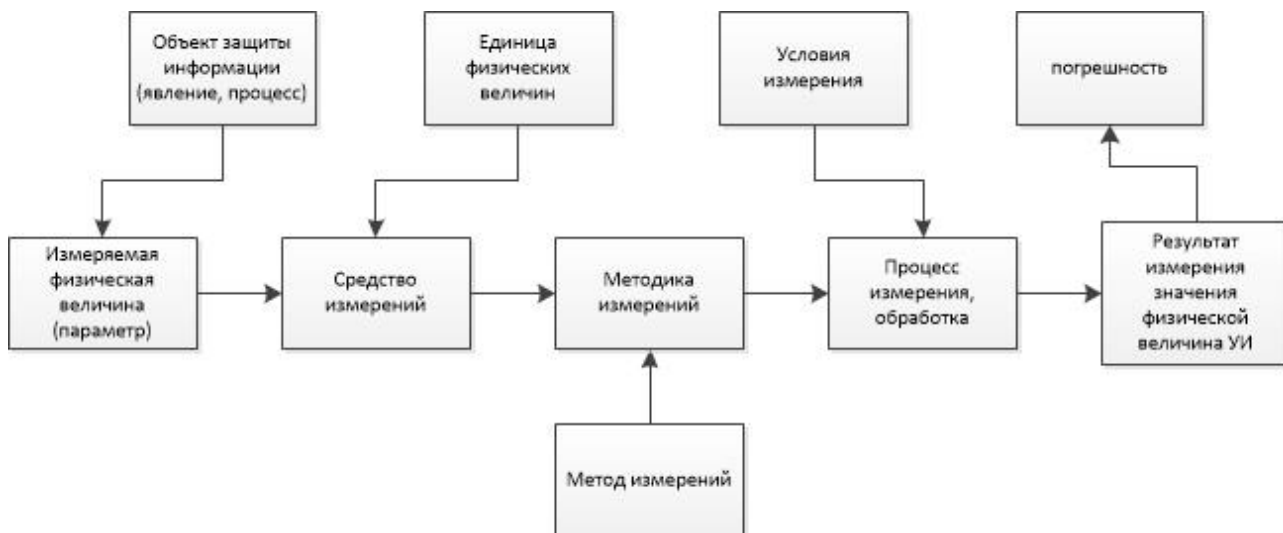
Рисунок 4 – Схема контроля (измерения) параметров, определяющих эффективность защиты информации
