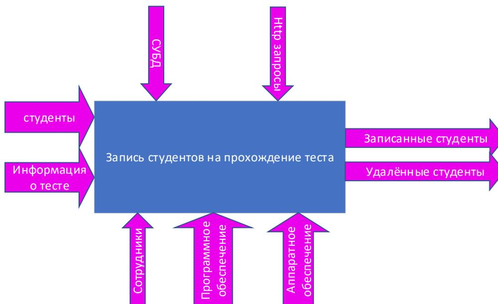
Рисунок 2.5 – Функциональная схема IDEF0 модуля записи студентов
